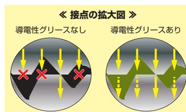
導電性グリースは隙間を埋めて通電面積を増やし、安定した導通を維持します。
